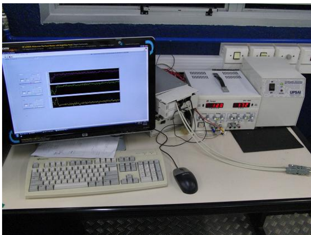
Figura 50. Ilustração da fonte de tensão utilizada, do sistema de aquisição de sinais e da tela do LabView aberta no monitor do computador.
