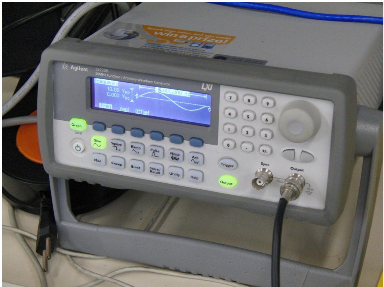
Figura 29. Gerador de funções produzindo uma onda senoidal.
